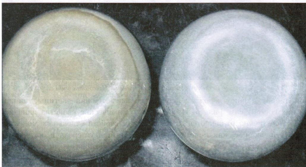
Рис. 3. Фильтр с каталитической засыпкой АС (слева). Исходная вода справа
