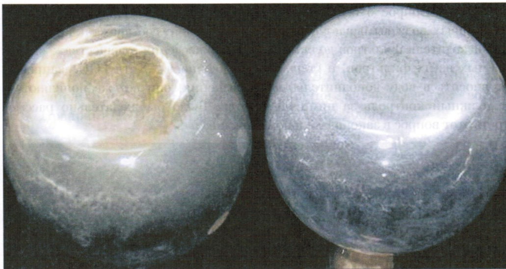
Рис. 1. Угольный фильтр с засыпкой БУ (слева). Исходная вода справа
