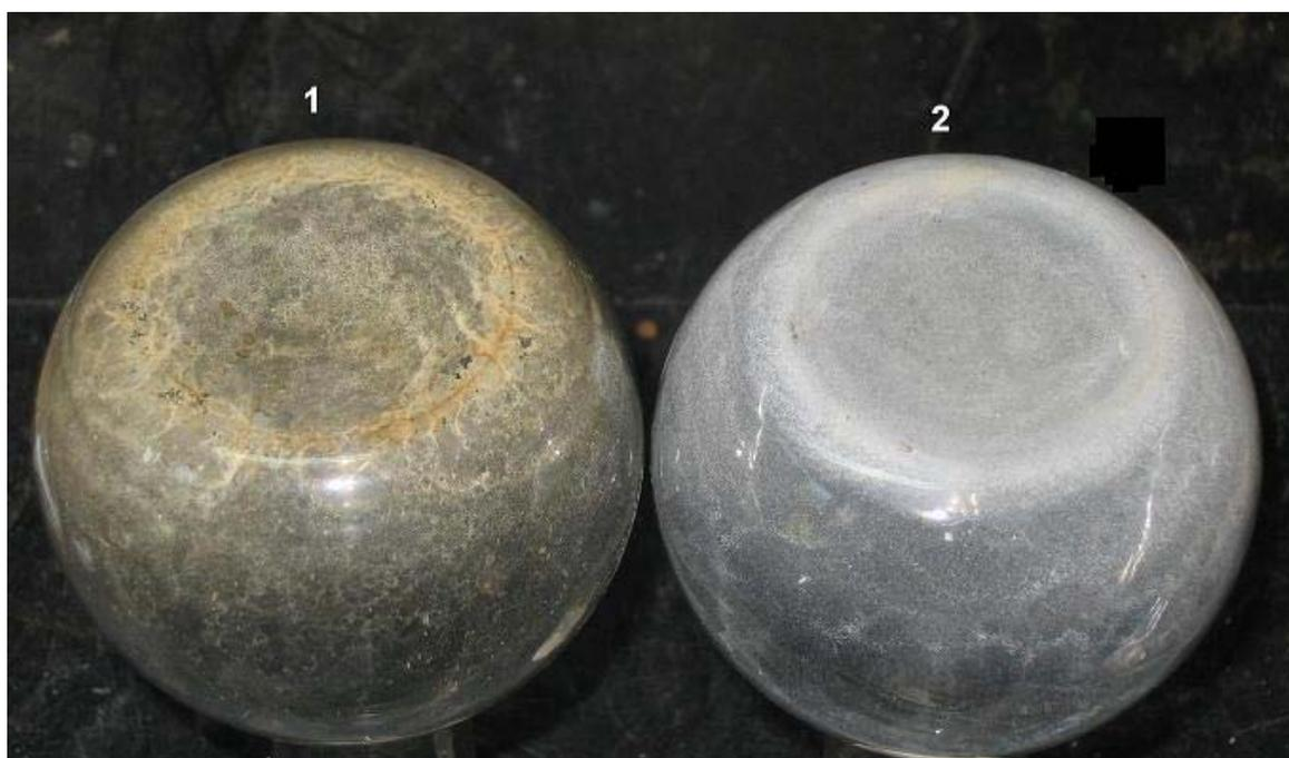
Рисунок 11. Осадок от выпаривания 0,5 л воды: 1 – водопроводная вода; 2 – родниковая вода целебного Шиловского источника, г. Нижний Тагил.
