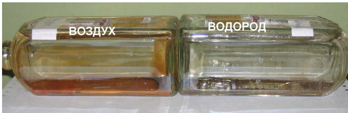
Рисунок 10. Наблюдение окисления металлического железа в воде. Слева - в газовой фазе воздух. Справа - в воду, первоначально содержащую растворенный кислород воздуха, вводился водород. Видно, что продукты окисления разные.
